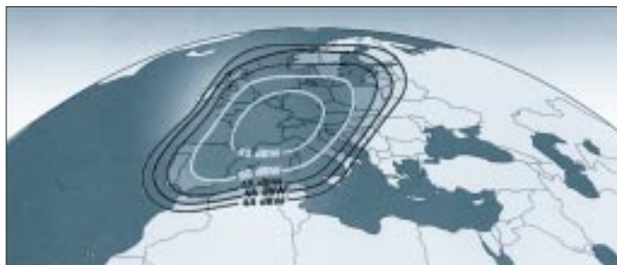
Widebeam (links) und Superbeam eines Eutelsat-II-Satelliten. Deutlich sind die unterschiedlichen Leistungsflußdichten für gleiche geografische Konturen ersichtlich.
