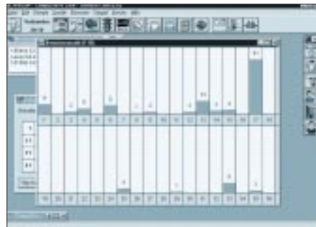
Bild 3: Die Auslastung der einzelnen Kanäle kann über ein Statusfenster wie mit einem „Panorama-Empfänger“ laufend überwacht werden.
