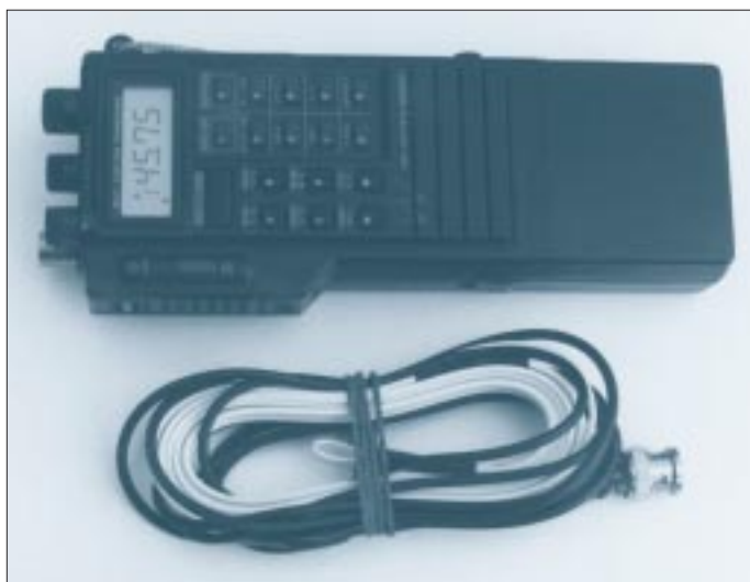
Bild 3: Einfach um die Hand gewickelt, dabei billig und leistungsfähig: die Duoband-Antenne fürs Handy Foto: DJ3RW
