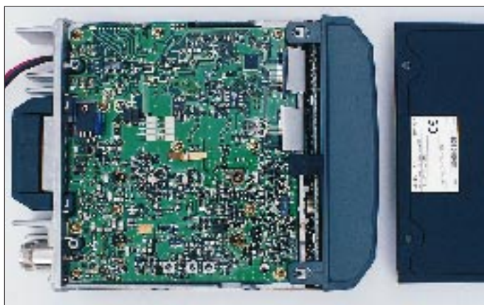
Der Blick auf die Geräteunterseite bietet nach Entfernen der Abdeckung etwas mehr SMD-Elektronik, dabei handelt es sich allerdings im wesentlichen „nur“ um die Gerätesteuerung.
